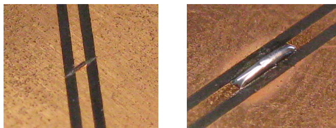
Abbildung 3: a) aufgetrennte Leiterbahn b) reparierte Leiterbahn
