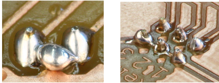
Abbildung 5: a) ungewollter Kontakt durch zu viel Lot b) kein Kontakt trotz löten
