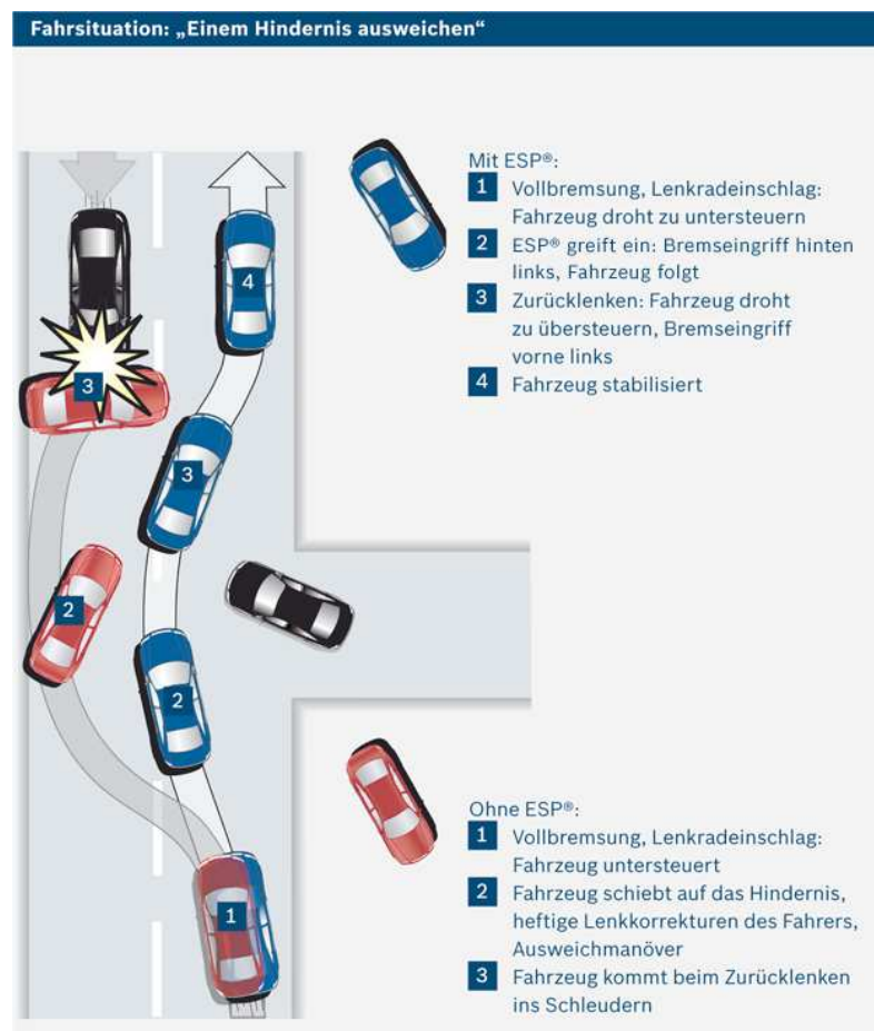
Abbildung 2.9.: Ausweichmanöver mit ESP. Quelle: Bosch [Rob09].
