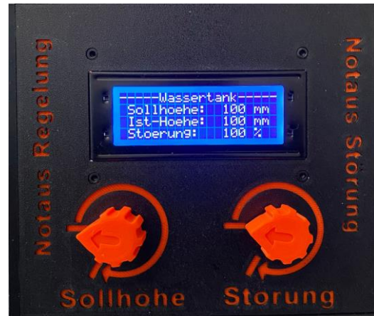
Abbildung 35: Deckel für die Benutzerkonsole mit LCD-Display
