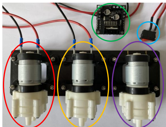
Abbildung 26: Pumpen mit Halterung, H-Brücke und Not-Aus-Schalter
