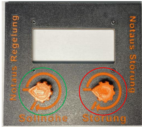
Abbildung 21: Deckel für die Benutzerkonsole mit Potentiometer
