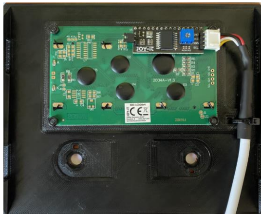
Abbildung 35: Deckel für die Benutzerkonsole mit LCD-Display
