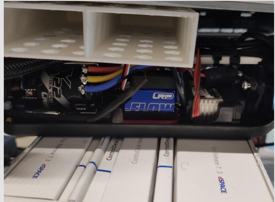
LRP Flow WorksTeam BL Regler eingebaut im CaroloCup Fahrzeug - Eigene Aufnahme
