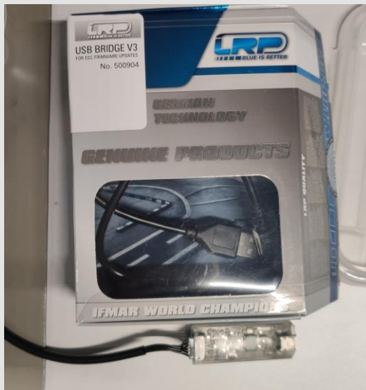
Zugeschnittene Darstellung der USB Bridge V3 für das Updaten der Firmware https://wiki.hshl.de/wiki/index.php/Datei:LRP_Firmware_Programmer.jpg
