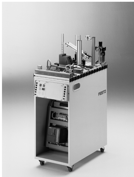
Station Montieren mit Wagen, Bedienpult und SPS Board
